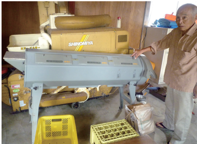
(上) 耕運機。田んぼを耕すための機械 (下) 後ろはもみすり機。もみからもみ殻を取って玄米にするための機械。手前は米選機。もみすりをした後の玄米からごみを取って、良質な玄米を選別するための機械
