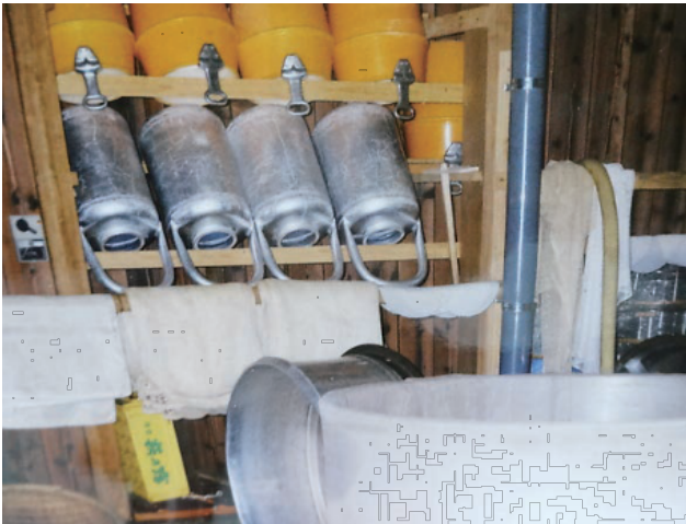
当時、お酒造りに使っていた暖気樽(通称ダギ)。65~70℃の湯をつめしっかりと蓋をして、直接酒母の中に入れて加熱したり氷を入れて冷やしたりする15~20ℓのアルマイト製の容器。
